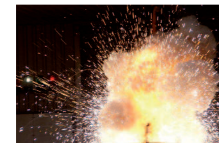
Arc flash 7 kA
